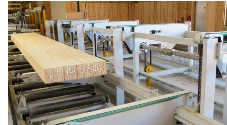
■ Entnahme von der PicoPress und Abtransport zur Hobelinie
