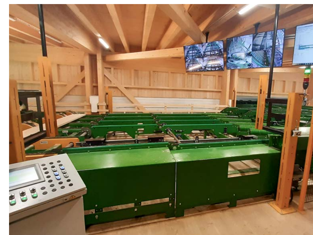
■ Beurteilplatz vor der Sortierung und Vereinzelung
