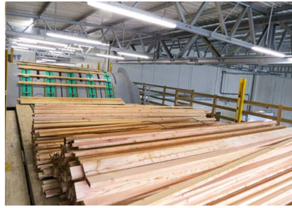
■ Schnittholzzuführung zur Sortierung – Entzerrer
