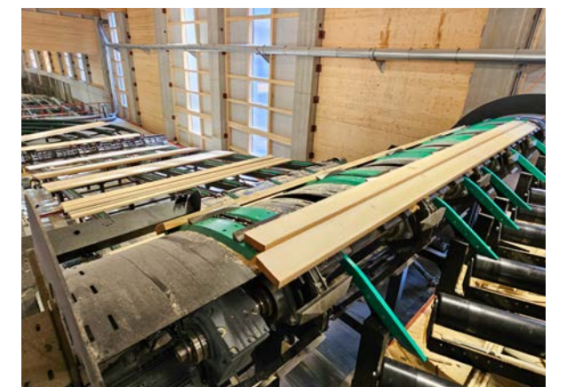
■ Von der Sägelinie wird die Ware über einen Steigförderer, Bogenförderer zur Paketlinie gefördert
