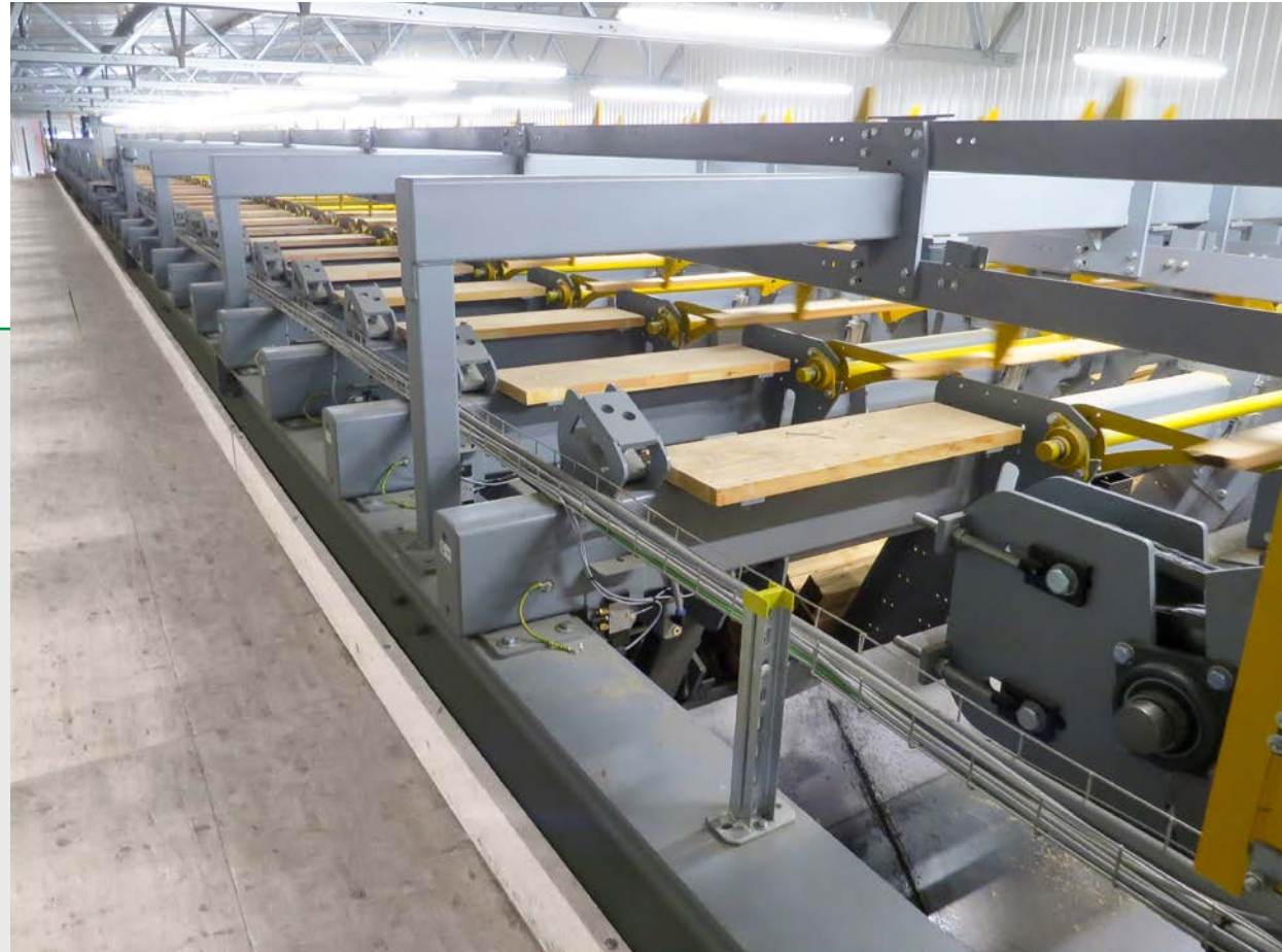
■ Boxensortierung mit Schleppförderer
