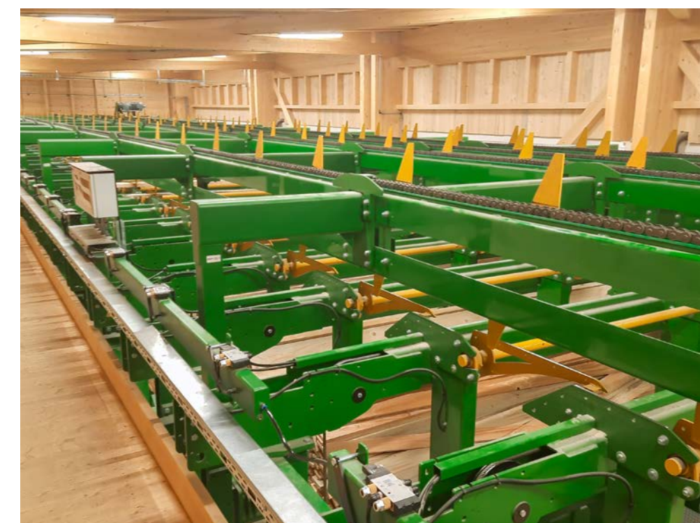
■ Sortierung mit 30 heb-/senkbaren Boxen
