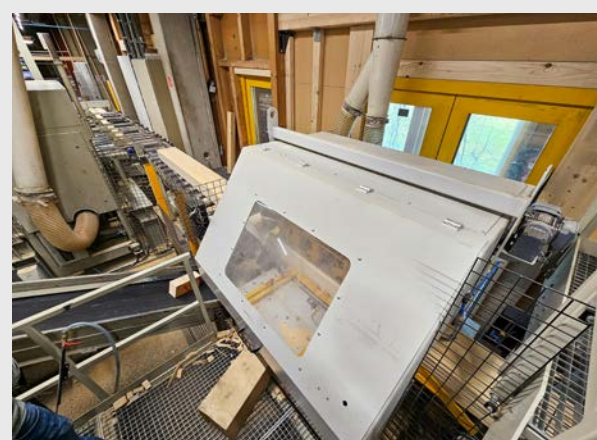
■ Kappsäge mit darauffolgender Keilzinkanlage TKZ
