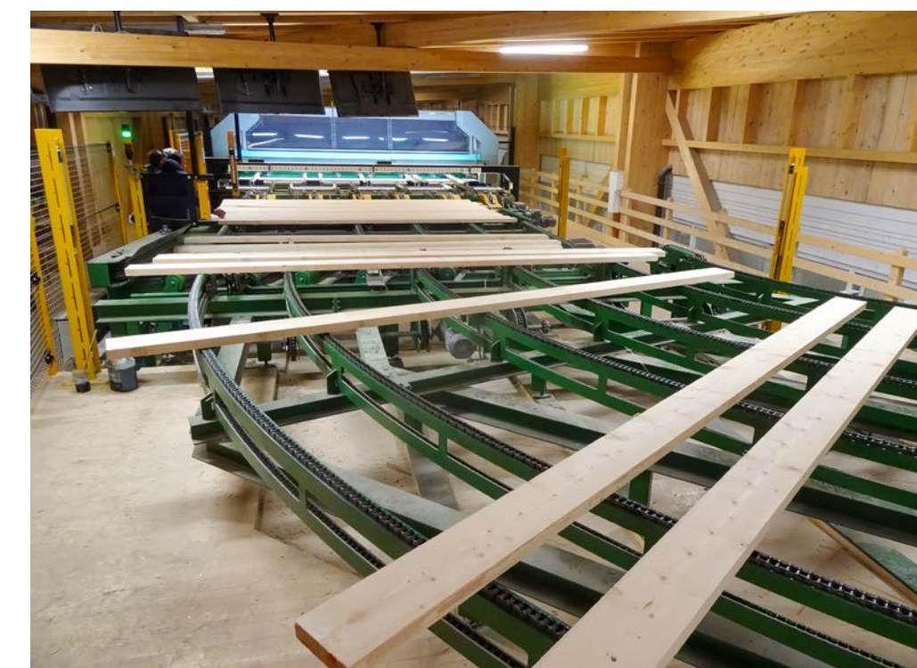
■ Zuführung zur Beurteilung und nachfolgendem Qualitätsscanner
