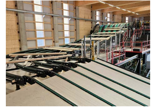
■ Zuführung zur Hauptwarenstapelung
