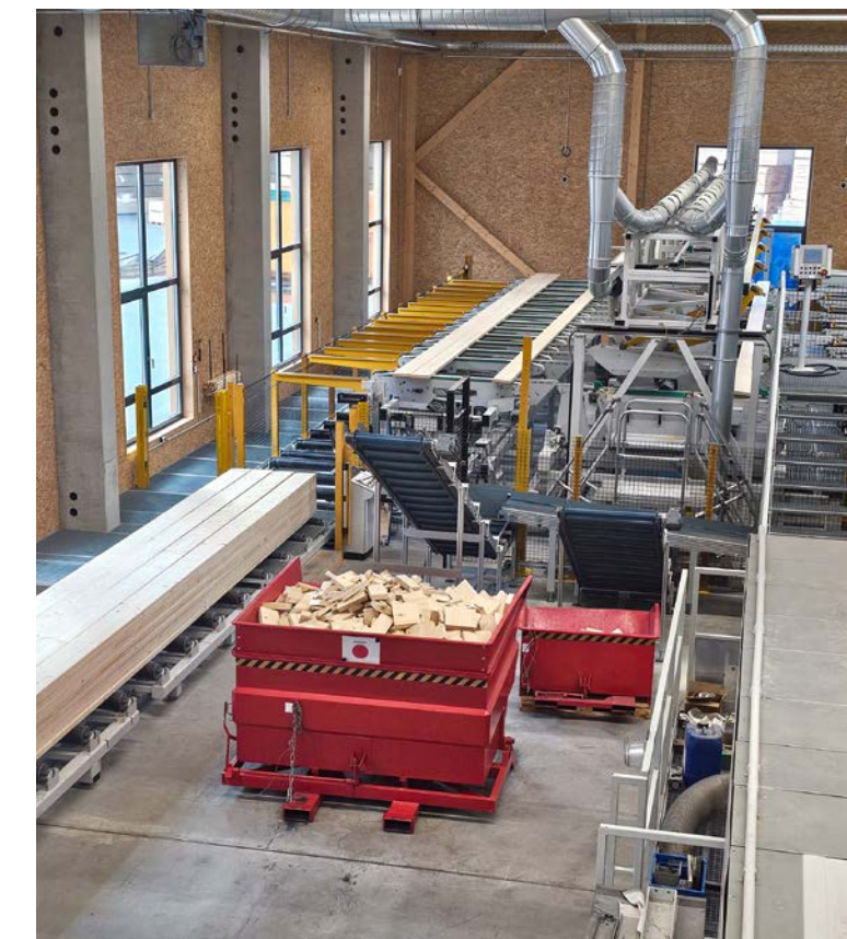
■ Mehrfachablängsäge mit Stapelanlage
