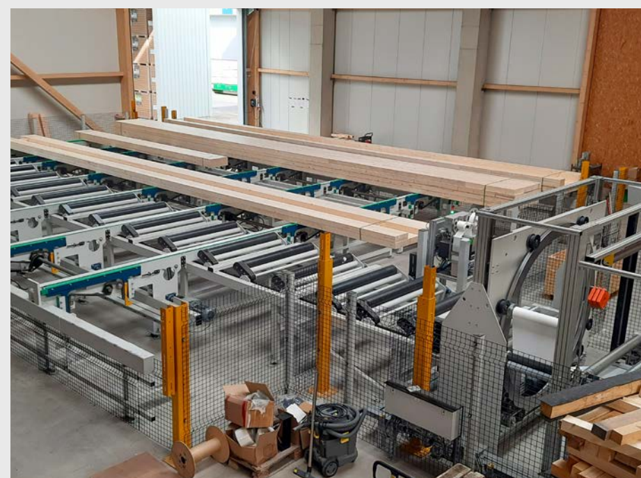
Paketfolierung mit Puffer
