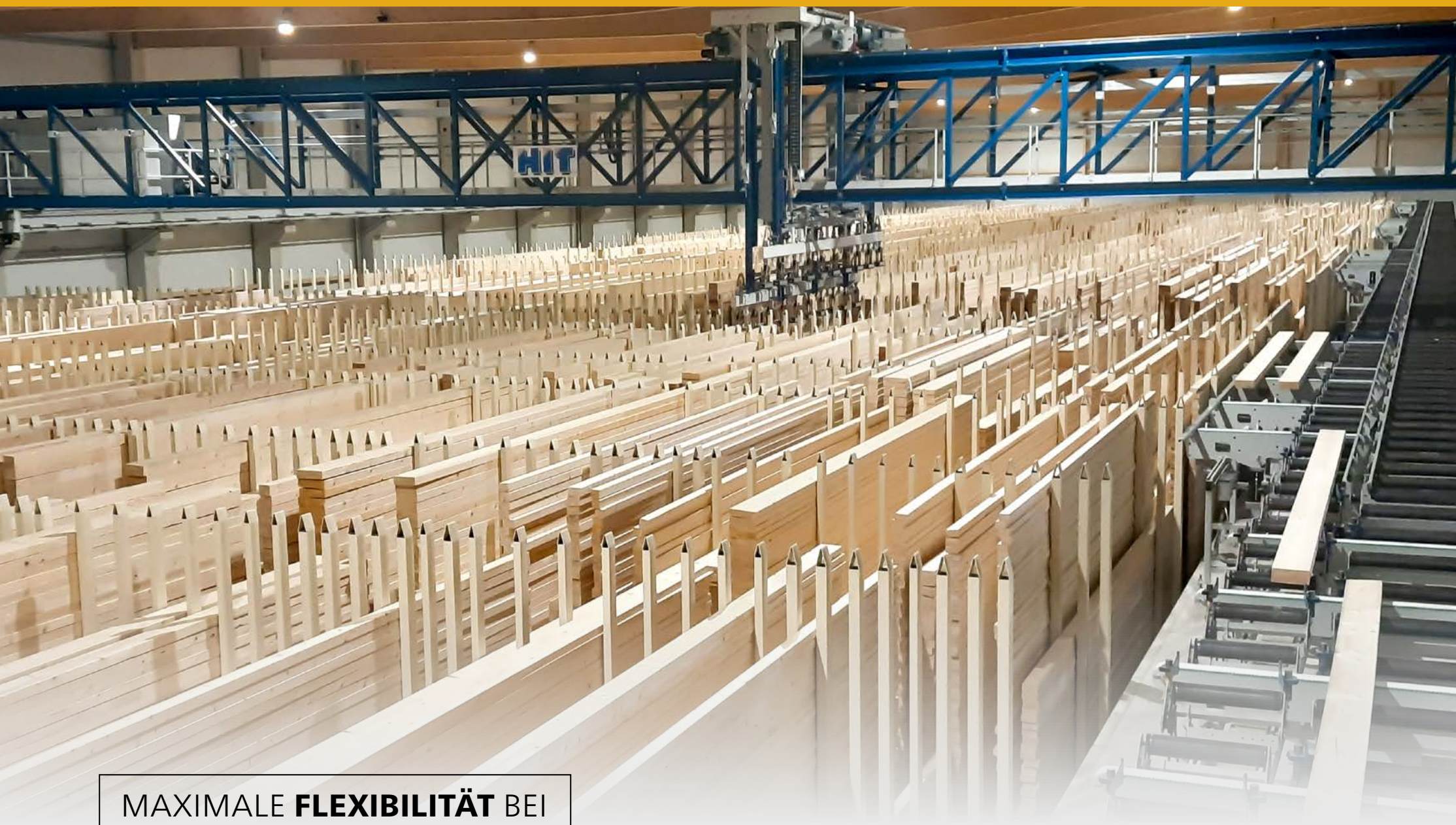
Ein- und Auslagerung erfolgt im Rungenlager mit dem Kommissionierportal PKS
