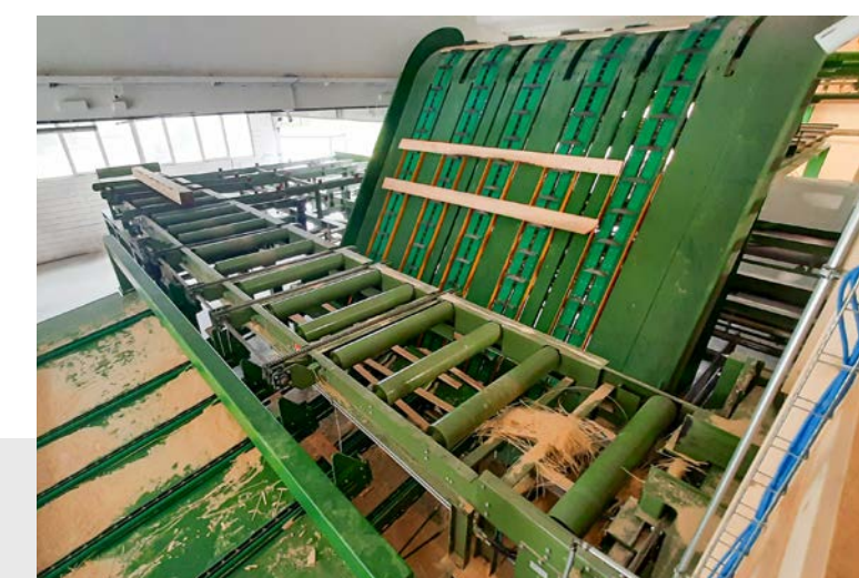
■ Übernahme von der Nachschnittlinie und Zuführung zur Sortierung
