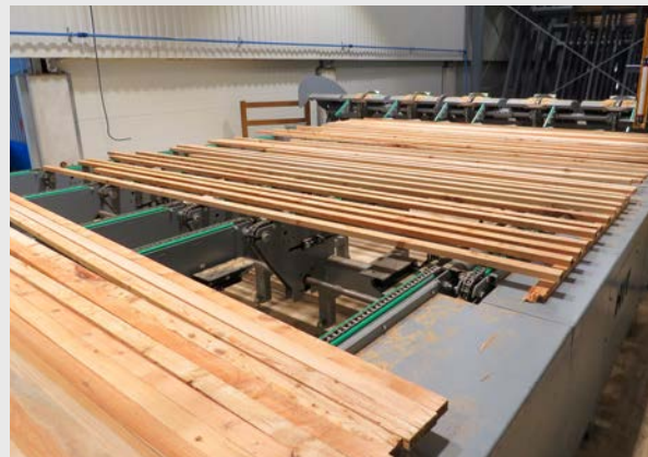
■ Zuführung zur Stapelanlage
