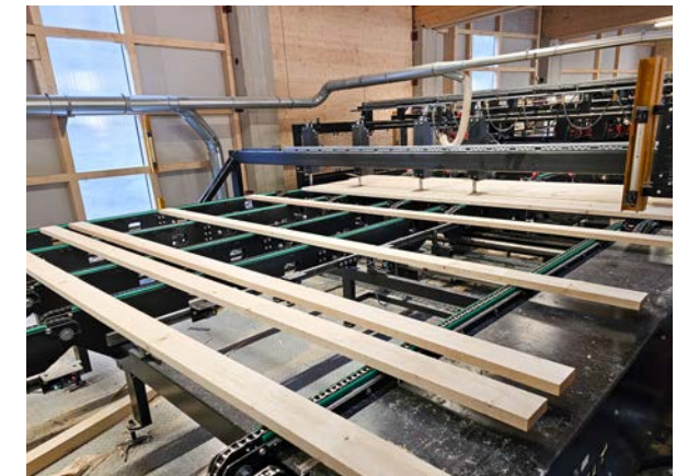
■ Zuführung zur Lagenvereinzelung
